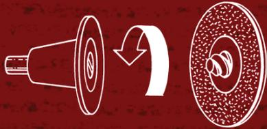
Schematische Darstellung des 3M™ Roloc™ Schnellwechselsystems
