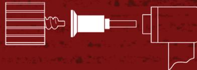
Schematische Darstellung des 3M™ Roloc™+ Schnellwechselsystems
